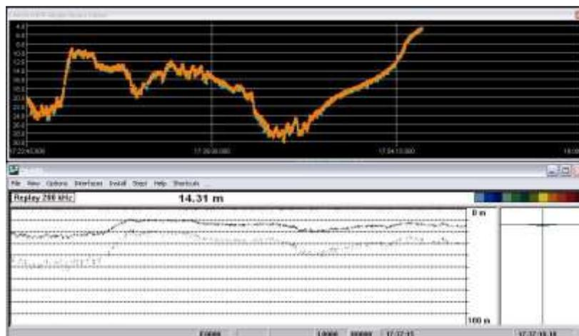
Comparação entre software de aquisição e registro bruto do ecobatímetro
